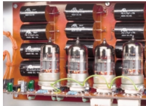
In der Vorverstärkung setzt Ayon vier russische Röhren ein (rechts), die dem vollsymmetrischen CD-1 seinen unverwechselbar flüssigen und warmen Charakter verleihen. Eine Bank von MOS-FETs (links) kontrolliert indes die Spannung der gematchten Trioden
