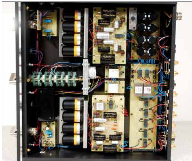
Vista interna del preamplificatore Ayon, sezione amplificatrice. Sarebbero centomila i particolari notevoli su cui concentrare l'attenzione. Ci limitiamo a segnalargliene tre: il formidabile commutatore multisezione deputato alla regolazione del volume che campeggia nella parte centrale del grande e robustissimo cabinet, le 4 valvole Siemens (sono quei barattolini neri simili a microlattine di Coca Cola), disposte in orizzontale, ancorate a supporti elastici per contenere la tipica microfonicità dei tubi ed infine i condensatori di accoppiamento tutti rigorosamente Mundorf serie top, a garanzia di una totale trasparenza nel trasferimento del segnale.
