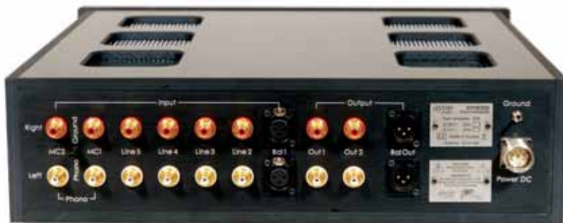
Ingressi e uscite RCA, e una soltanto XLR, di ottima qualità. Sulla sinistra i due ingressi fono MC, a destra la connessione multipolare per l'alimentatore.
