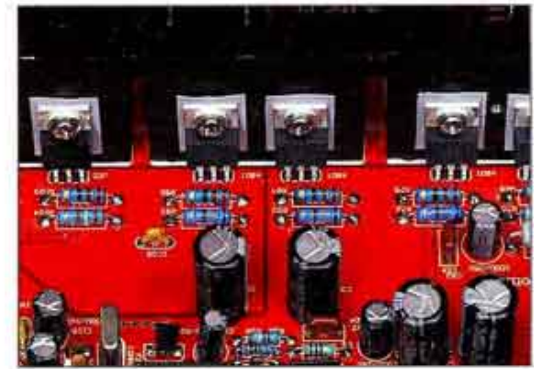
Heizer: Ordentliche Kühlkörper für die Spannungsregler sind unabdingbar
