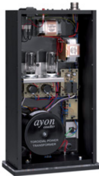
Zweimal Anodenspannung versorgt Line- und Hochpegelstufe getrennt
