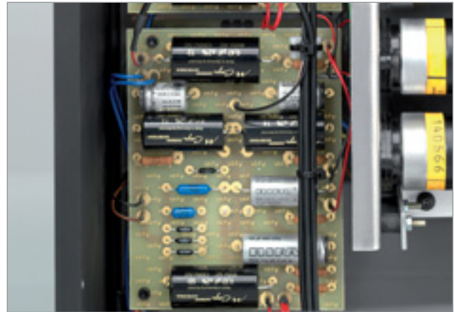
Abgesehen von Mundorfs Siber/Gold-Prachtstücken werden auch Profi-Kondensatoren des Herstellers Rifa verbaut
