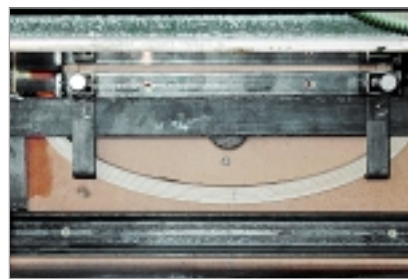
Unter hohem Druck trocknet der Leim zwischen den Sperrholzschichten
