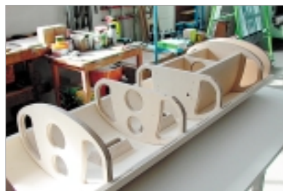
Die Ausschnitte in den Verstrebungen sind strömungsgünstig verrundet
