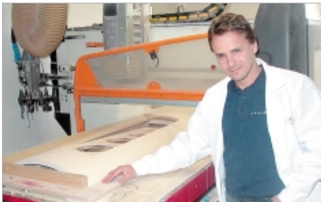
Zweite Station: Christian Fuchs und seine 3D-Fräse bringen die Gehäuseteile auf das benötigte Maß
