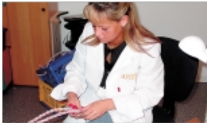
Vierte Station: Hier entsteht die Innenverkabelung in Handarbeit
