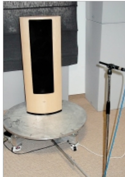
Der motorisierte Drehtisch vereinfacht die Messung des Rundstrahlverhaltens
