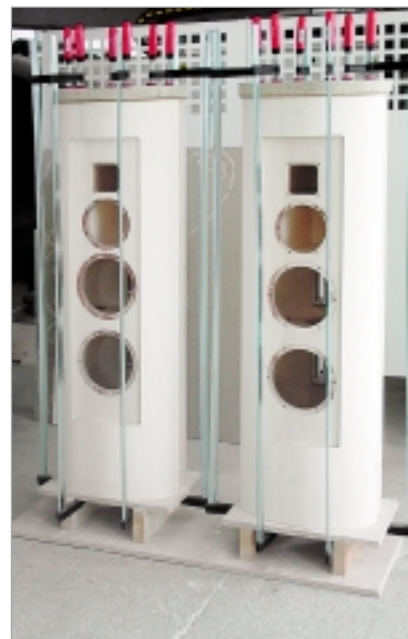
Boden und Deckel komplettieren die bis auf die Lackierung fertigen Gehäuse
