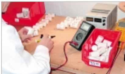
Kondensatoren werden vor dem „Matching“ akribisch selektiert
