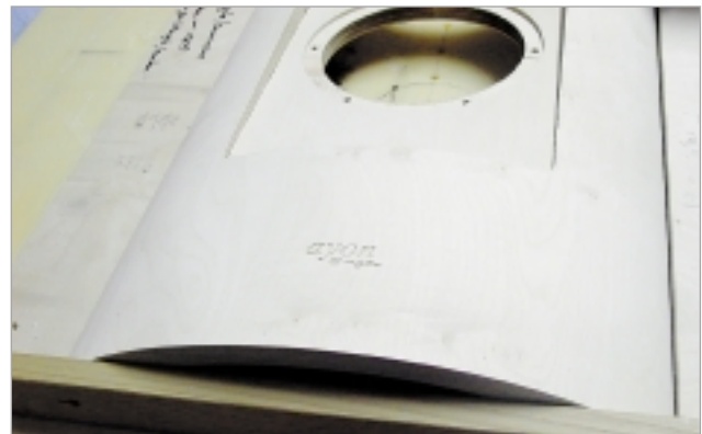
Hier wird die Schallwand eingepasst und der Markenname sowie die Typenbezeichnung ins Holz gefräst
