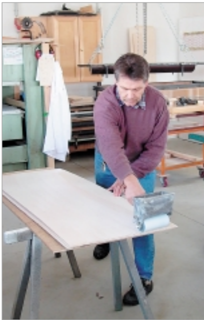
Erste Station: Für ein Gehäuse werden fünf Schichten Sperrholz verleimt
