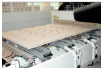
Dritte Station: Eine CNC-Machine stellt Deckel und Verstrebungen her
