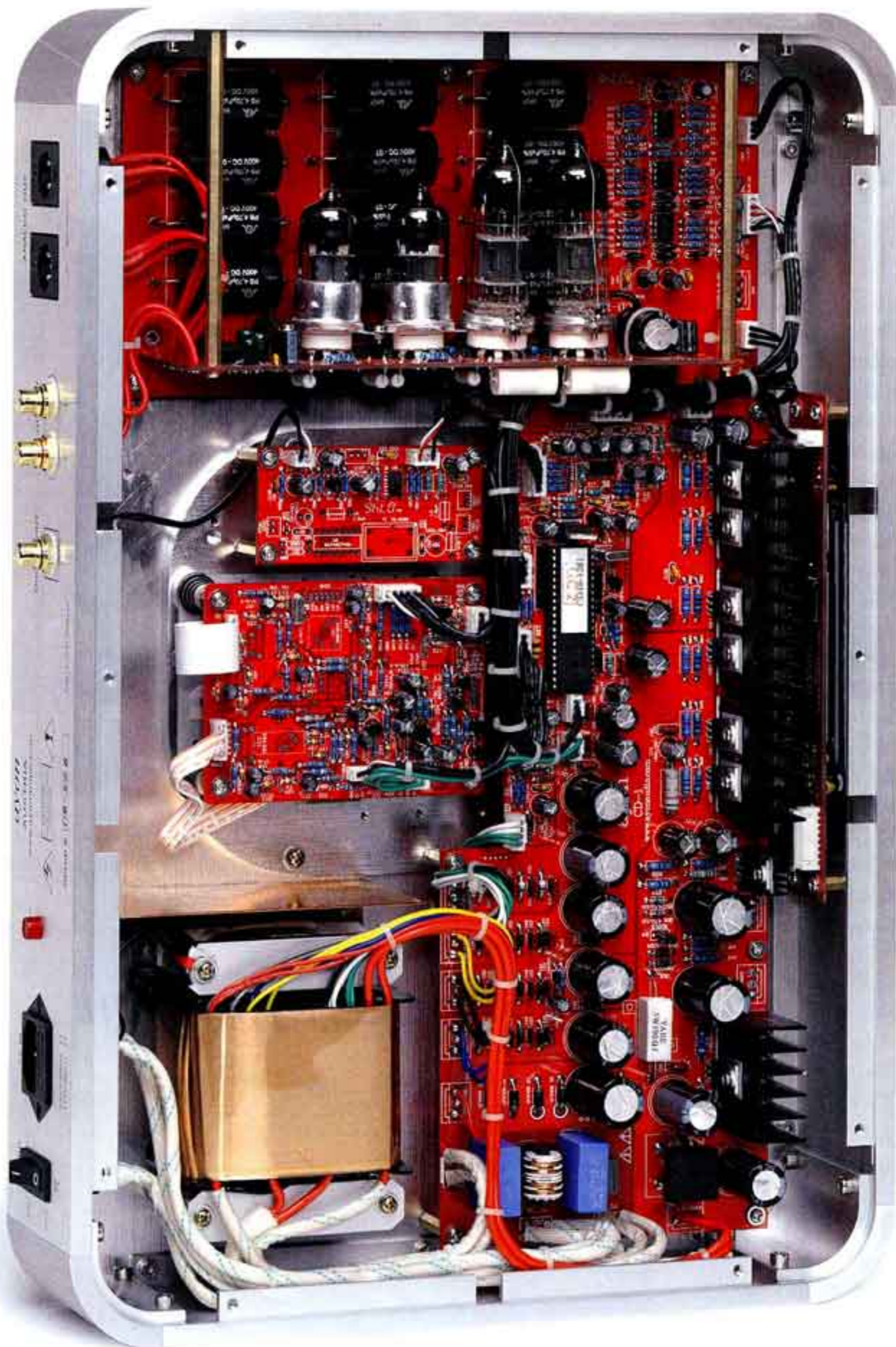
Der Materialeinsatz im CD1 ist wahrlich nicht ohne. Ins Auge fallen besonders die Baugruppen, die einer stabilen Stromversorgung dienen: Spannungsregler und Kondensatoren in Reih und Glied. Der große Trafo ist mit Kupfer abgeschirmt
